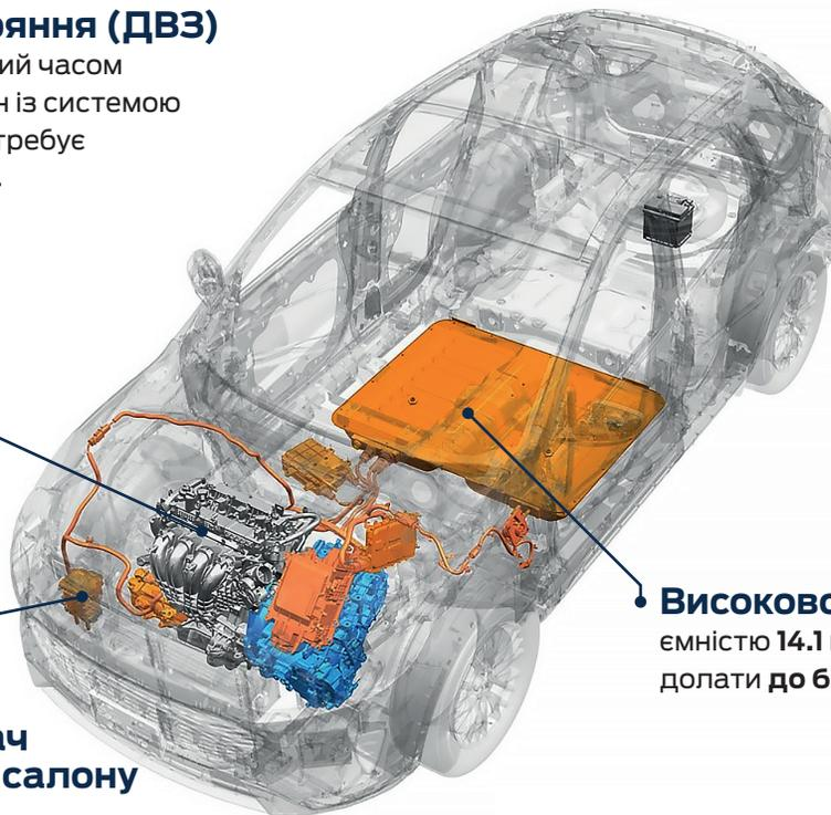
**Високовольтна батарея** ємністю 14.1 кВт/год. дозволяє долати до 69 км на електротязі.
